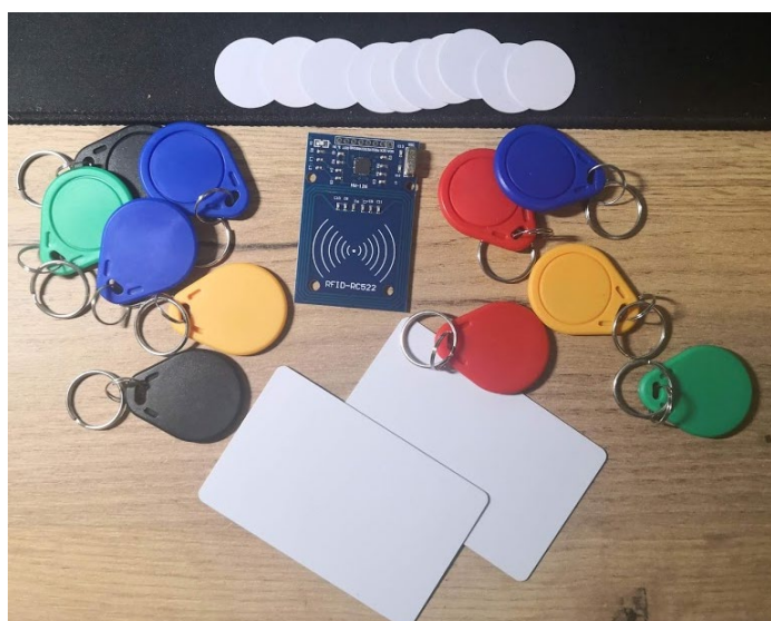
Slika 15: RFID oddajnik in odzivniki različnih oblik.
