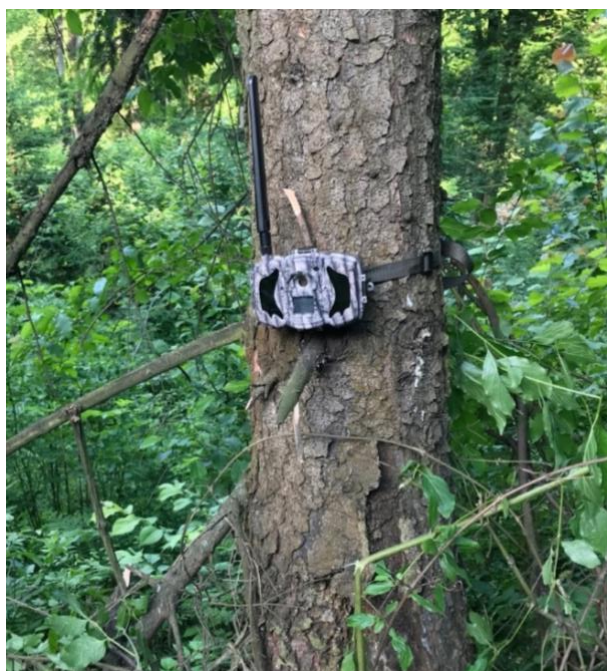
Slika C: Kamera BolyGuard MG984G-36M, postavljena na drevesu na podvozu Mali viadukt. (foto: D. A. Banič)
