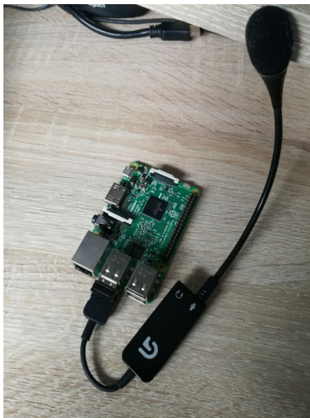
Slika 2: Slika vezja Raspberry Pi, brez povezanega napajalnika. Vidna je priključena USB zvočna kartica ter uporabljen mikrofonski slušalki.
