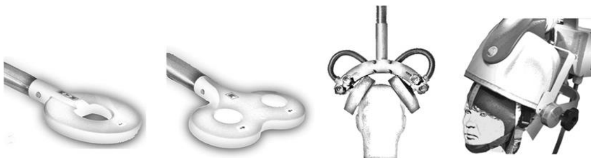
Slika 2.01. Shematski prikaz različnih vrst TMS tuljav. (od leve proti desni) Okrogla tuljava, metuljasta tuljava, dvojno-stožičasta tuljava, H-tuljava (Rotenberg et al., 2014).
