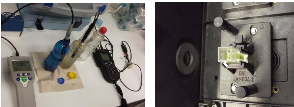
Slika 5: Merjenje nitratov in prevodnosti v vzorcih vode (levo) ter vzorec v spektrofotometru (desno) (Foto: Ž. Muhič).
