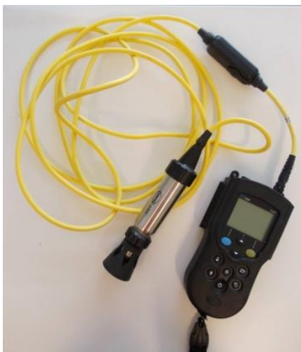
Slika 3: Naprava Hach HQ40d s sondo LDO za merjenje količine raztopljenega kisika in temperature vode (Foto: Ž. Muhič).
