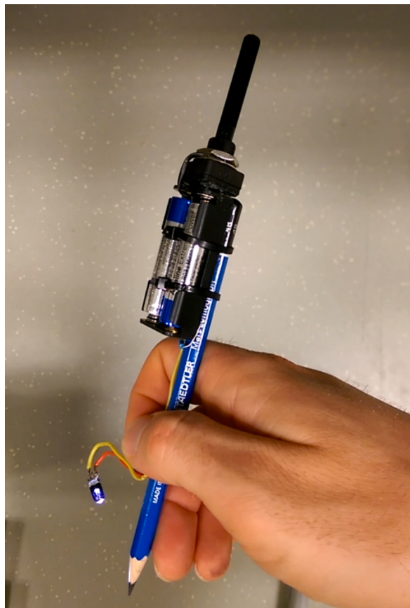
Slika 13: Svinčnik z LED svetilko za boljše ocenjevanje globine.
