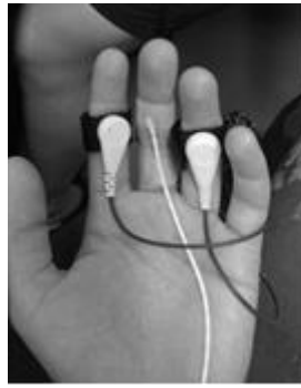
Slika 5: Namestitev elektrod za merjenje prevodnosti in temperature kože
