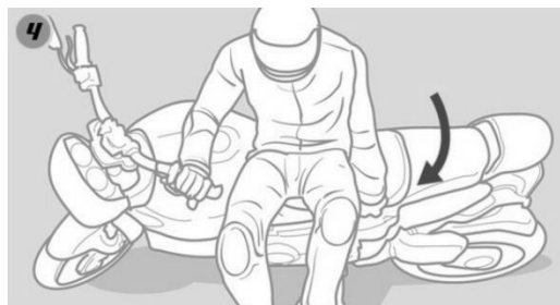
Slika 88: Oprijem zadnjega dela motocikla.
