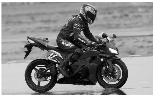
Slika 10: Zaviranje motocikla in prenos teže na sprednji del motocikla.
