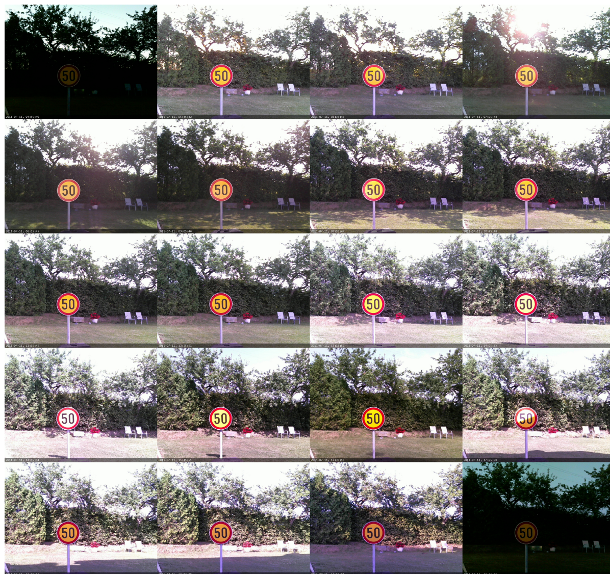
Slika 3.6: Vzorec 20 od 198 testnih slik za določanje mejnih vrednosti barvne segmentacije v barvnem prostoru HSV. Slike so bile zajete vsakih 5 minut skozi celoten dan, prikazana pa je vsaka 10-ta slika. Na slikah so vidni različni svetlobni pogoji in posledično različno obarvan prometni znak za omejitev.
