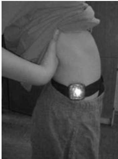
Slika 2: Primer namestitve merilnika pospeška
