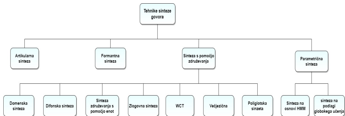
Slika 10: Na sliki so prikazane tehnike sinteze govora. Tehnike sinteze govora lahko v grobem razdelimo na artikularno sintezo, formantno sintezo, sintezo s pomočjo združevanja in parametrično sintezo (Vir: [18]).
