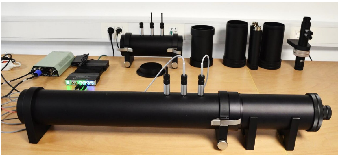
Slika 26: Merilni sistem Brüel & Kjaer tip 4206-T pripravljen za meritve absorpcijskih koeficientov.
