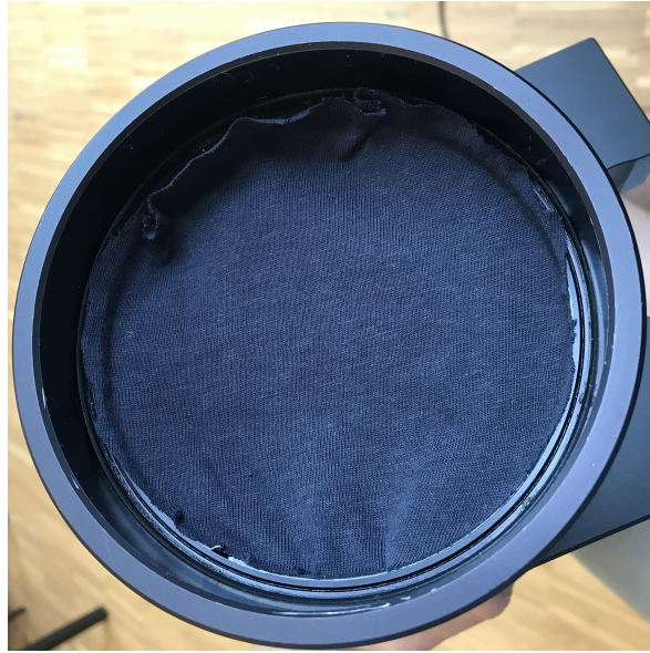
Slika 27: Prikaz namestitve vzorca v impedančno cev – na sliki je vzorec 100-% bombaža.
