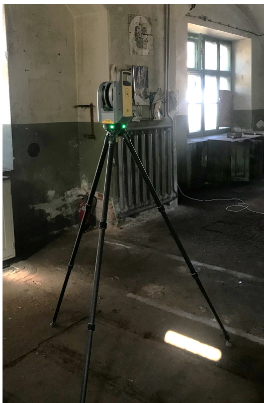
Slika 20: Prikaz uporabe 3D skenerja med meritvijo
