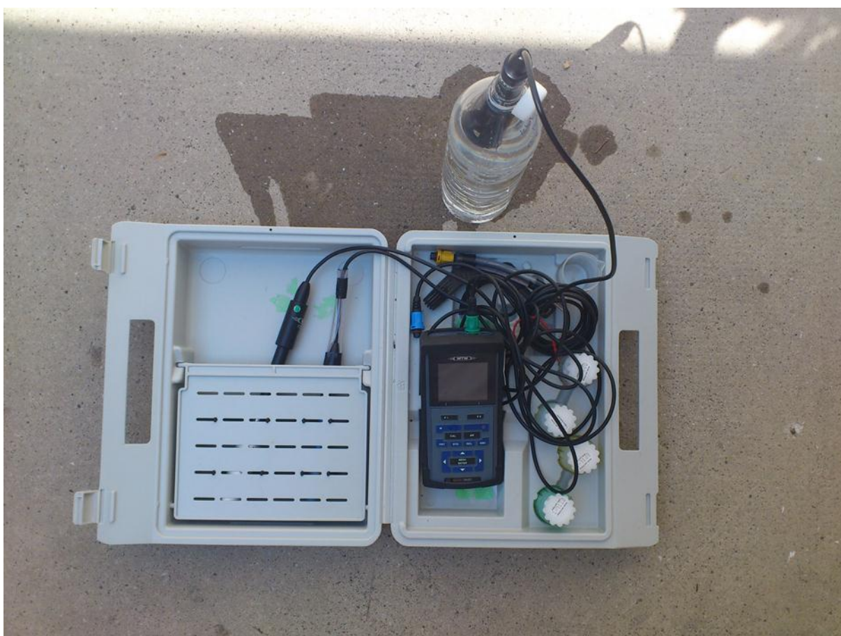
Slika 11: Terenski merilec Multi 3420 z elektrodami za meritev pH, kisik in prevodnost (L. Rušnjak)
