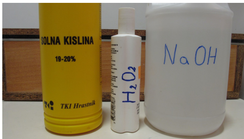
Slika 23. Raztopine za jedkanje (solna kislina in vodikov peroksid) in razvijanje (natrijev hidroksid). Z leve proti desni so solna kislina, vodikov peroksid in natrijev hidroksid.
