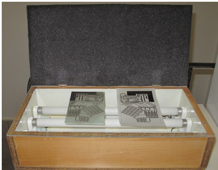
Slika 22. Ročno izdelana priprava za osvetljevanje.
