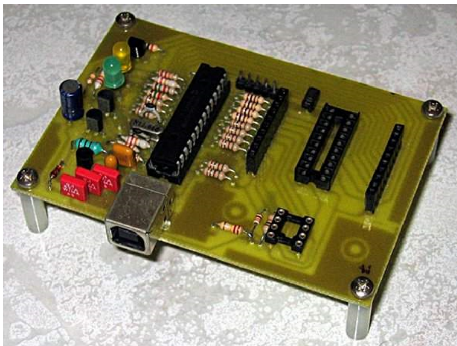
Slika 30. Prototip odprtokodnega programatorja Open Programmer v0.9.x [24].
