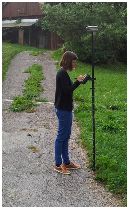
Slika 11: Vrisovanje območja na terenu s prenosnim satelitskim sprejemnikom (Foto: Martin Kržišnik, 2013)
