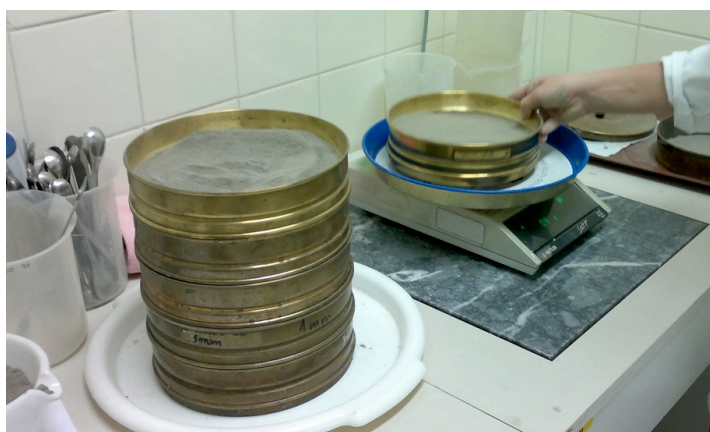
Slika 7: Tehtanje delcev substrata. Foto: L. Rušnjak.
